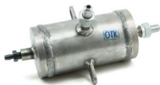
СУ - сосуды уравнивательные предназначены для поддержания постоянного уровня жидкости в одной из двух соединительных линий при измерении уровня жидкости в резервуарах с использованием датчиков разности давлений.
