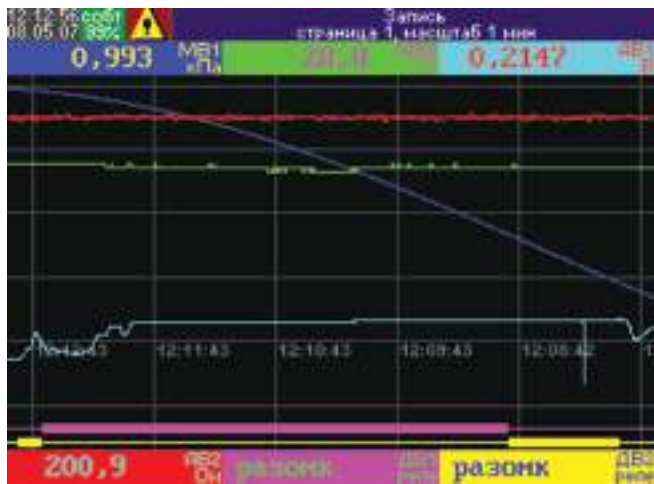
1. Тренды. Предусмотрена вертикальная и горизонтальная ориентация трендов, а так же отображение на темном и светлом фоне. Масштаб временной оси задаётся при настройке. Для исполнения 3 возможно раздельное отображение трендов.
