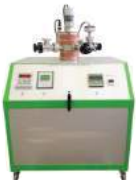
Рисунок 2 – Мобильная вакууметрическая поверочная установка
